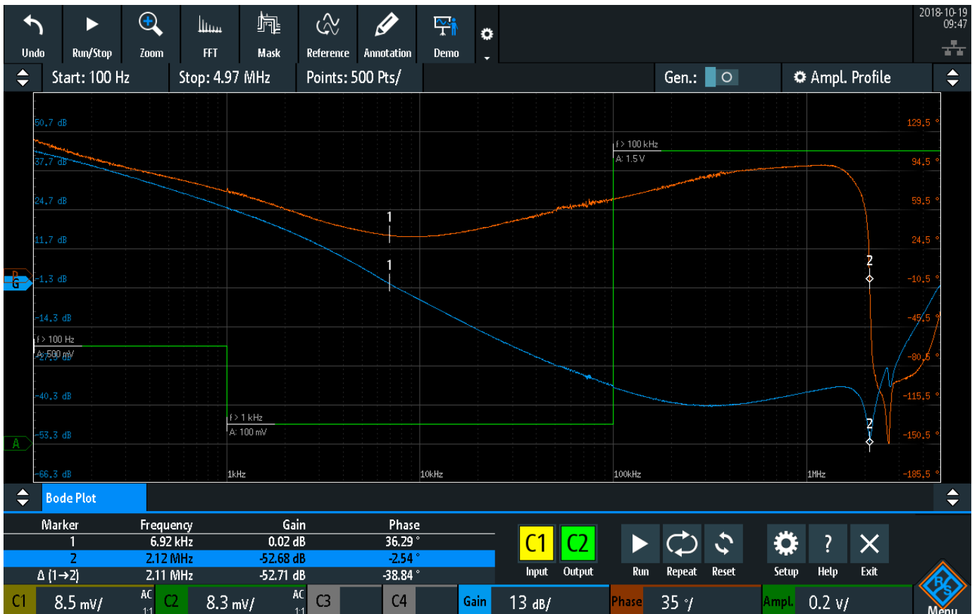
R&S®RTB-K36 주파수 응답 분석(Bode plot) 옵션은 패시브 필터 및 증폭기 회로를 포함한 다양한 전자 기기의 주파수 응답 특성을 분석합니다
