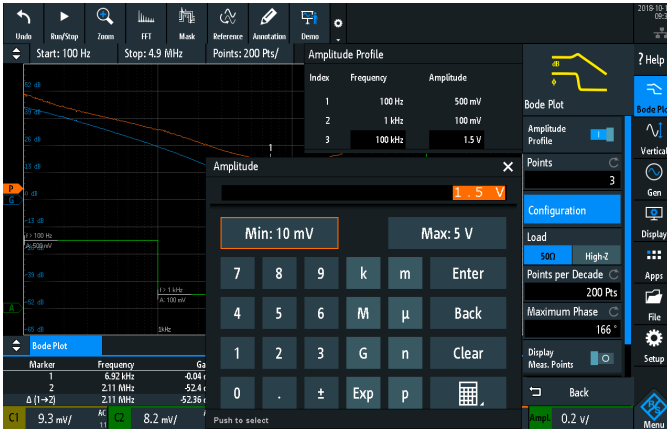
DUT의 노이즈 동작을 억제하기 위해 측정 도중 발생기 신호의 진폭 출력 레벨이 변경될 수 있습니다
