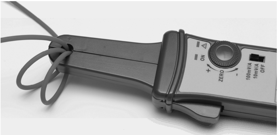
圖 4:提高電流靈敏度方式
