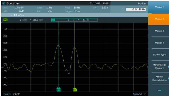
R&S®FPC-B22: 내장 프리앰프를 이용한 고감도 측정.
