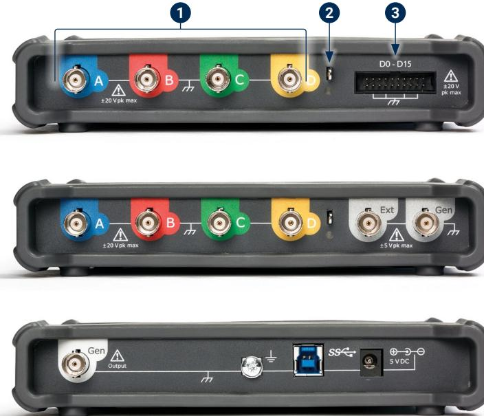
*Nota: qui sono mostrati i modelli a 4 canali PicoScope serie 5000D sono mostrati qui. Altri modelli possono avere una diversa disposizione di connettori. Per dettagli consultare la scheda dati dell'oscilloscopio.*
