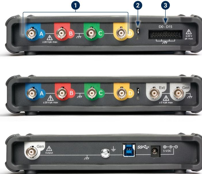
Remarque : les modèles PicoScope série 5000D à 4 canaux sont illustrés ici. D'autres modèles peuvent disposer d'une configuration de connecteurs différente. Reportez-vous à la fiche technique de l'oscilloscope pour plus de détails.
